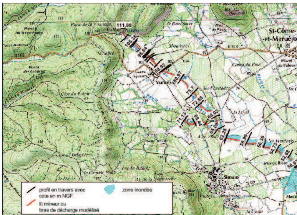
Figure 49 : Visualisation des niveaux d'eau du ruisseau de Maruéjols pour une crue de type 100ans
